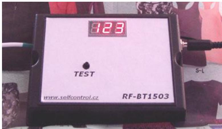
Zařízení RF-BT1503 je bezdrátový radiofrekvenční přijímač povelů odeslaných ovladačem DOK2 s konverzí do výstupního datového formátu podporovaného digitálními číselníky řady BT1503.
